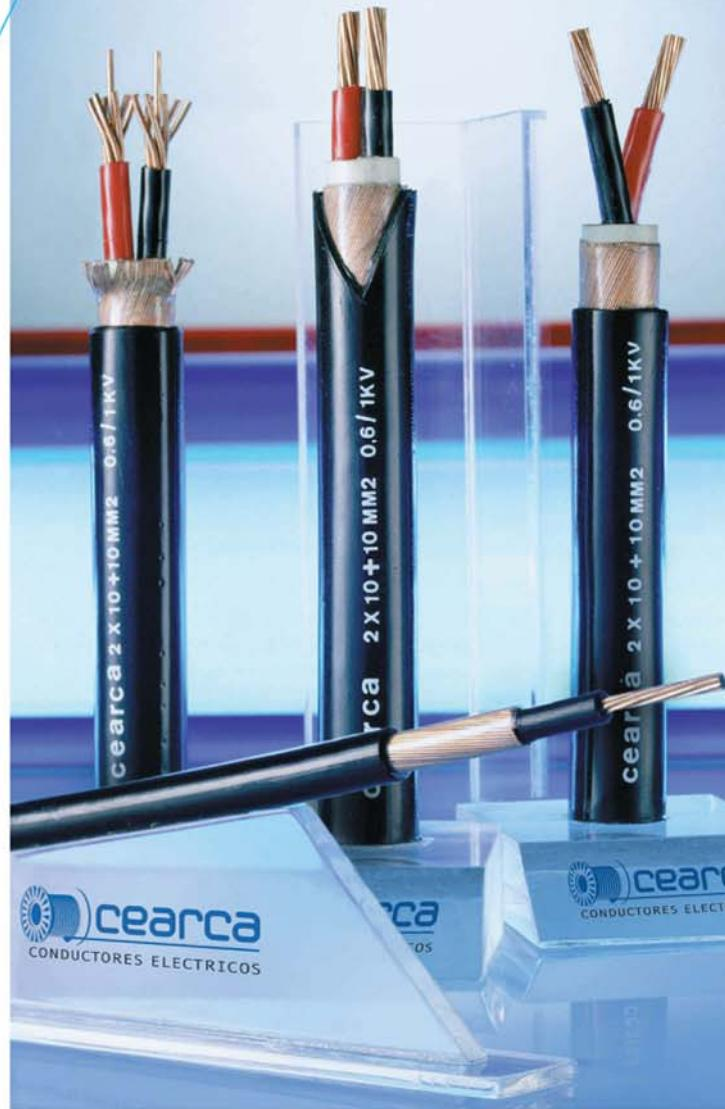
construida de alambres de cobre recocido o aluminio, cobertura cerrada, encintado separador de material sintético, aislación de polietileno reticulado.
